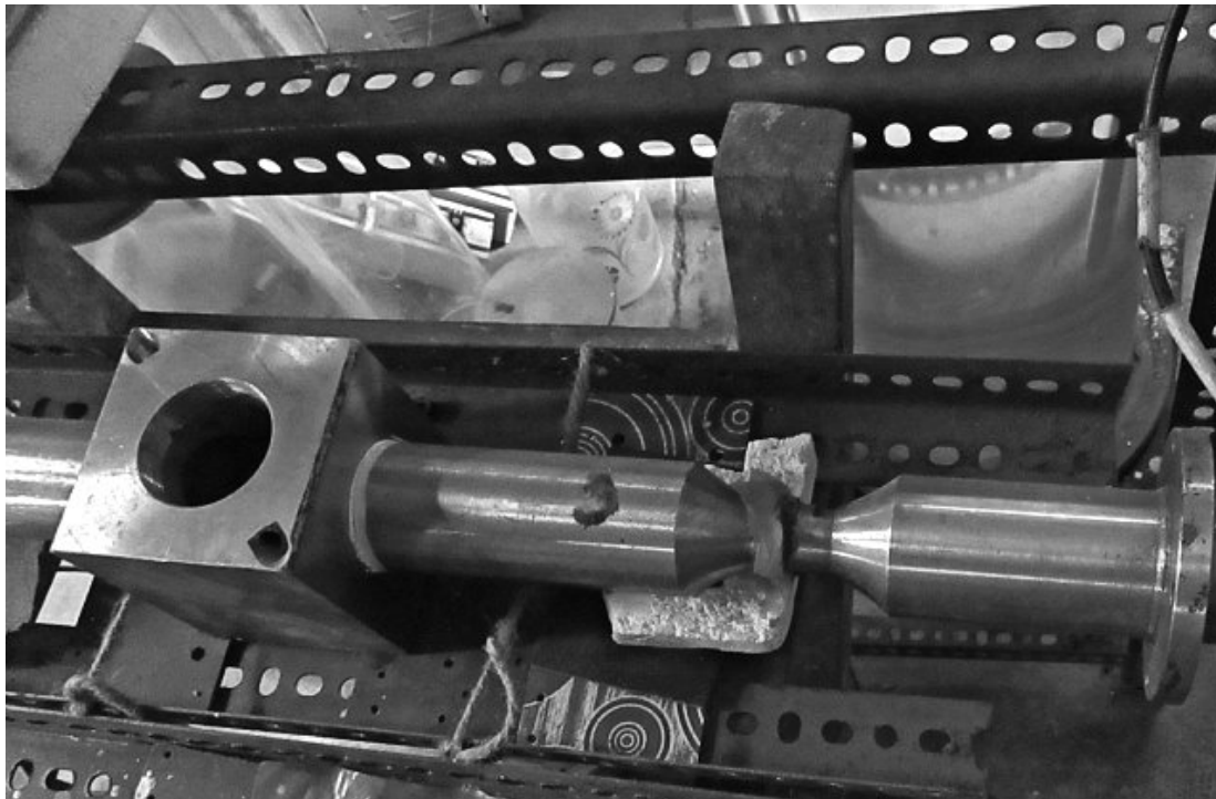
Abbildung 4. Suhas Ralkas ultraschallgetriebene Brennstoffaufbereitungsanlage auf der Grundlage von wässrigem Wolframschlamm. Man beachte die drei Sonotroden, die als Schalleiter dienen. Sie leiten die Ultraschallwellen zum behandelten Schlamm.
