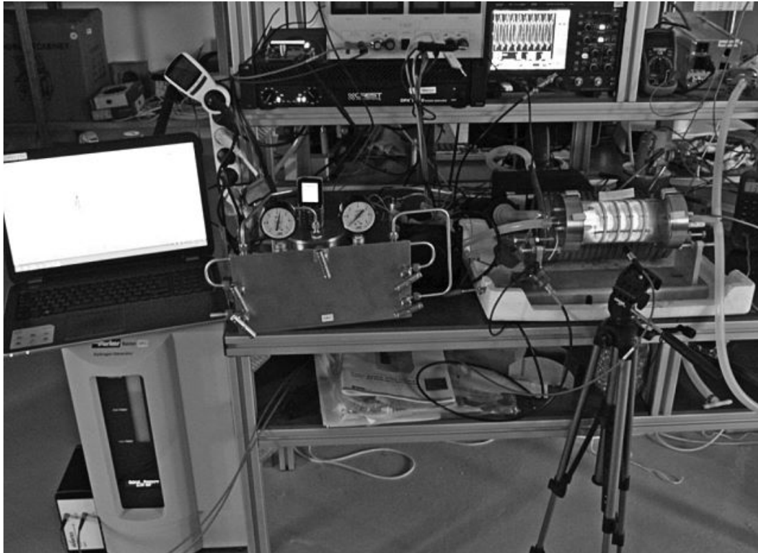
Abbildung 10b. Der experimentelle Prüfstand, ohne Wärmetauscher, mit gepulstem Anregungswasserstoffplasma.
