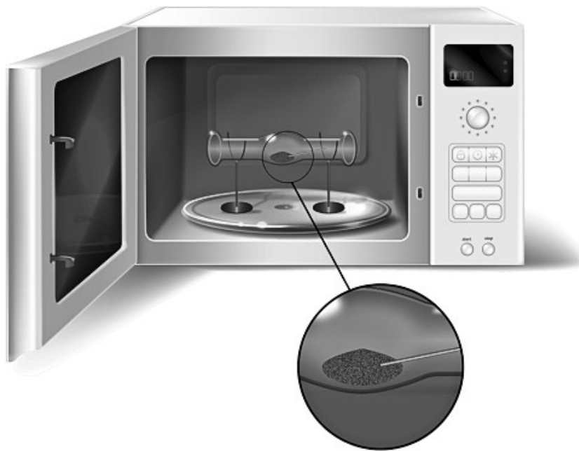
Abbildung 12a. Mikrowellengerät als Staubfusionsreaktor, betrieben mit Kohlestaub. Die Bauch-Horn-Struktur hält das oszillierende Plasma im Inneren der Quarzglasröhre und schließt die akustische Energie mit bis zu 600 Hz in der Röhre ein.
