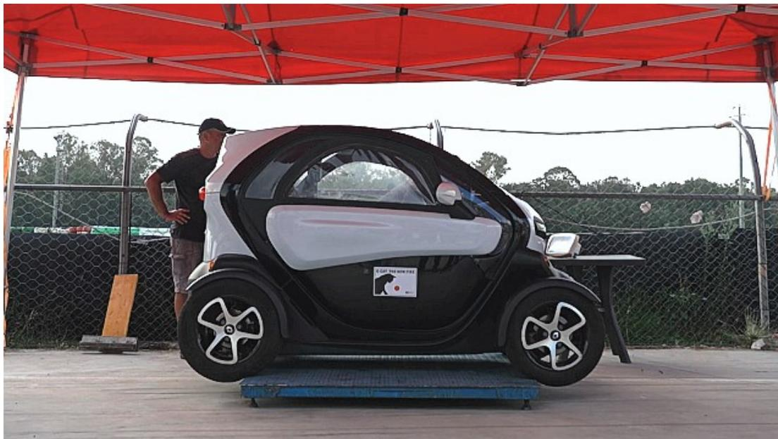
**Das Wiegen des modifizierten Renault Twizy 80 vor der sechsstündigen Demonstration auf einer Rennstrecke in Latina, Italien. Nach der Demonstration wurde festgestellt, dass das Fahrzeug seine Reichweite auf das 2,7-fache vergrößert und den Ladezustand der Batterie um 33 Prozent erhöht hat.**
