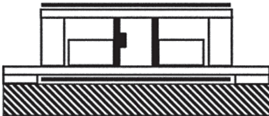
Abbildung 21. Querschnitt durch zwei Potenzialexperimente, bei denen die LEC-Elektroden (die senkrechten schwarzen Linien) von ihren Enden aus gesehen vertikal ausgerichtet sind und die Arbeitselektrode auf der linken Seite eine Ablagerung auf ihrer Innenfläche aufweist (die schwarze Verdickung). Der schraffierte Bereich ist der Labortisch, und die horizontalen schwarzen Linien sind Elektroden zur Anwendung elektrischer Felder im Inneren des LEC. Bei den offenen Kästen mit ihren schwarzen Umrissen handelt es sich um Kunststoffteile. Die beiden inneren Kunststoffhalterungen sind an den Metallelektroden befestigt, um diese aufrecht zu halten.
